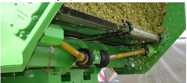
Теперь фуражные прицепы Silo-SPACE могут быть оборудованы механическим приводом транспортера от карданного вала и передаточной коробки.
